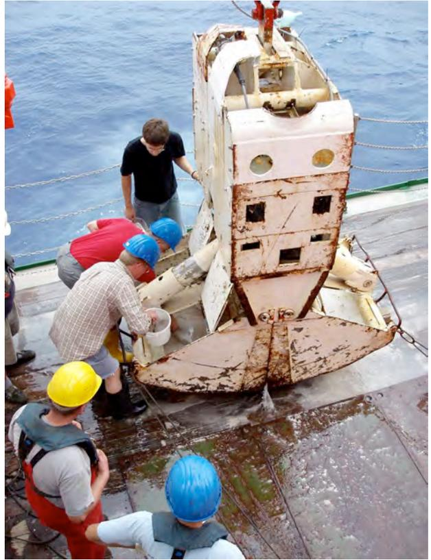
Abb. 3: Biologen entnehmen Proben von Ozeanbodensedimenten aus dem TV-Greifer.
