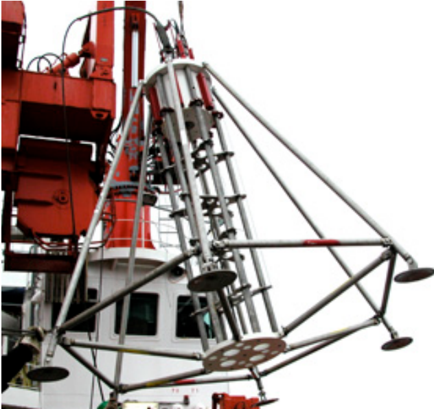
Die „hard-ground“ Wärmestromsonde wird eingeholt
