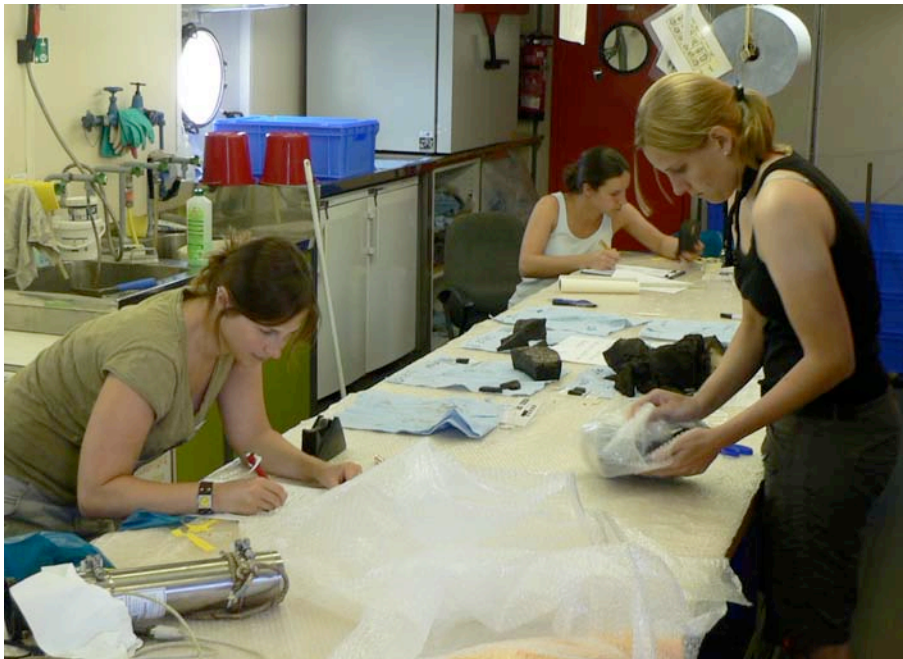
Ein typischer Arbeitstag im Geolabor an Bord des Forschungsschiffs Sonne: Proben sortieren – aufsägen – waschen – beschreiben – fotografieren – verpacken – und sicher für den Transport nach Deutschland verstauen
