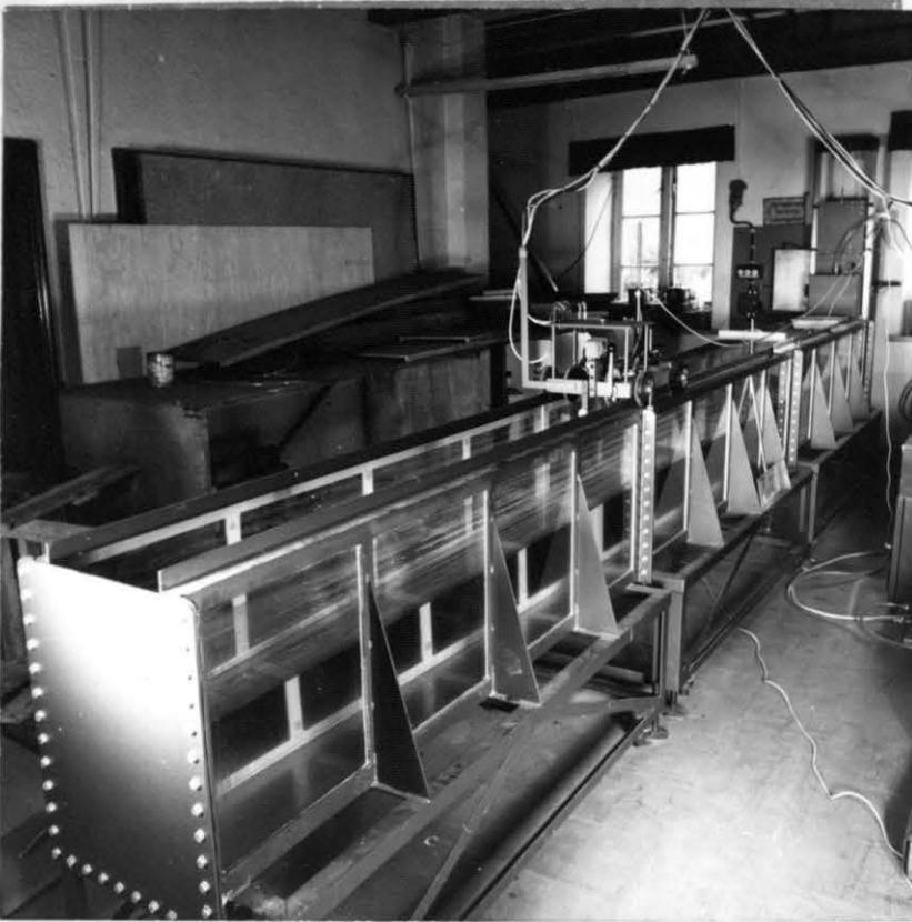
Abb. 3.16 Versuchstank mit Schleppwagen
