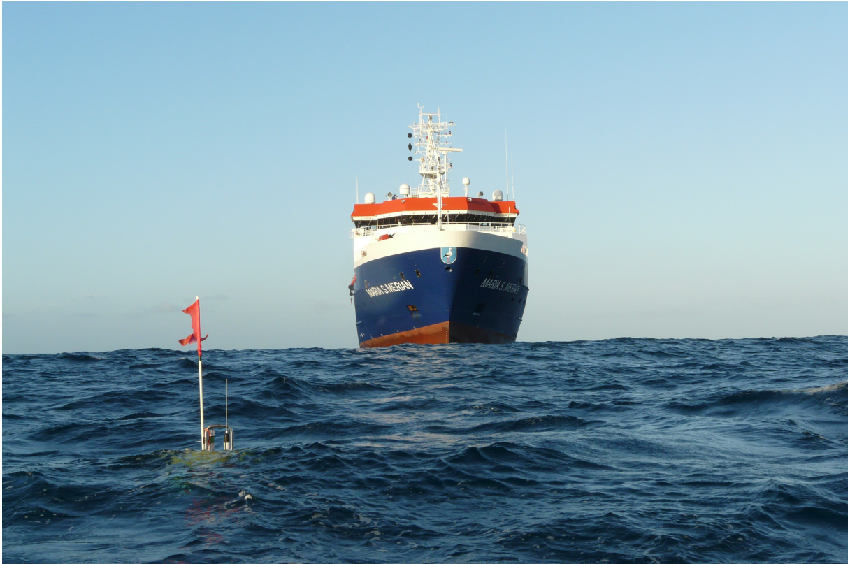
Bild 1: Maria S. Merian nähert sich einem vom Meeresboden wieder aufgestiegenem Ozeanboden-Hydrophon (OBH). Foto: U. Herter
