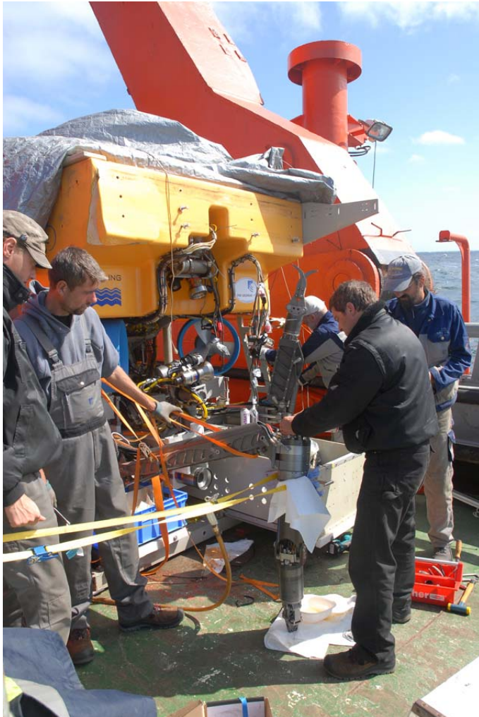
Abb. 7: Reparatur des ORION-Manipulators des ROV Kiel 6000 auf dem Achterdeck der SONNE. Oben links im Auftriebskörper des ROV ist der Einschlag der Schiffsschraube deutlich zu erkennen.
