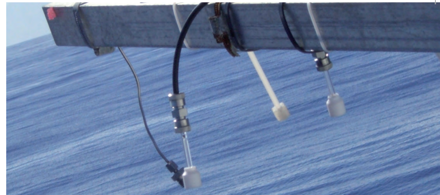
Leitungen zur Luftprobennahme, an deren Enden Pumpen Luft ansaugen.
