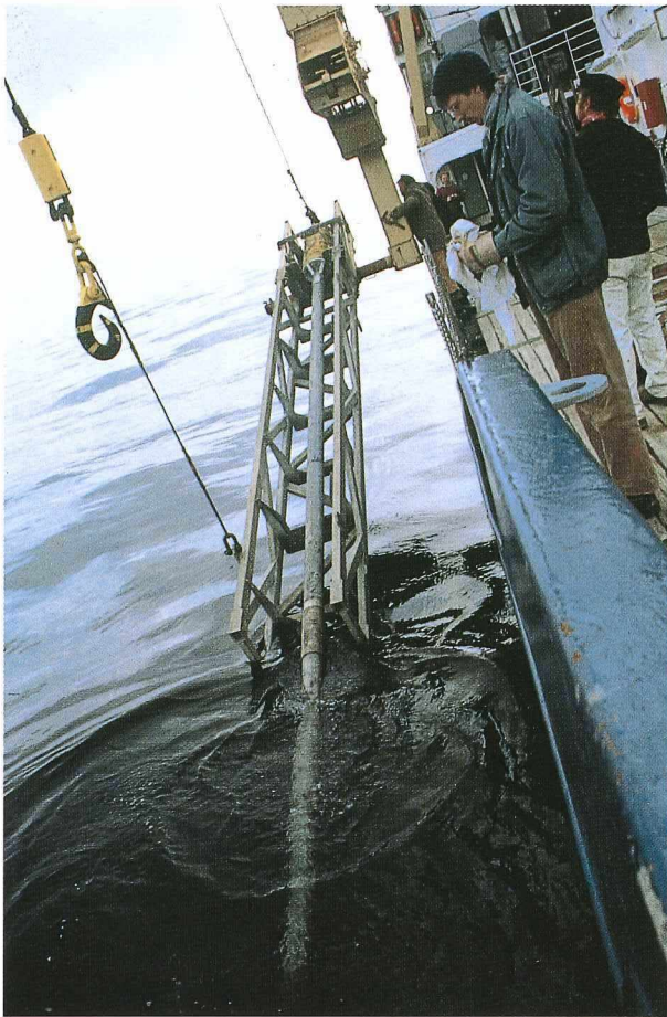
Abb. 3: Schwerelot zur Gewinnung langer Sedimentkerne. Das Gerät trägt ein Bleigewicht und dringt durch das Eigengewicht in den weichen Meeresboden ein.
