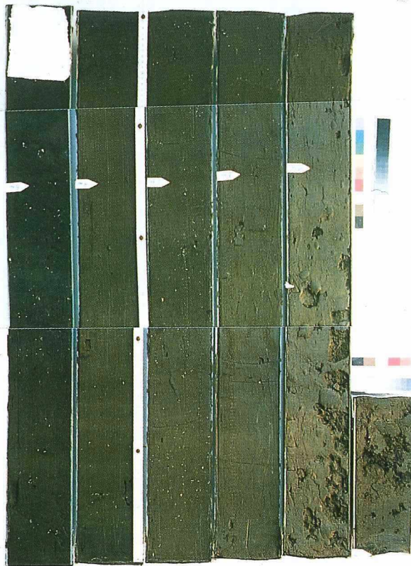
Abb. 4: Der Bohrkern aus der Kieler Förde (KF 1) zeigt überwiegend schlickige Ablagerungen.
