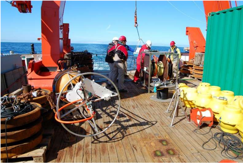
Abbildung: Auslegung der Irminger See Verankerung. Eisenbahnräder als Tiefseeanker, ein Instrumenten-rahmen, die Oberflächen-Telemetrikugel sowie gelbe Auftriebskugeln sind gut zu erkennen. (Foto: J. Karstensen)
