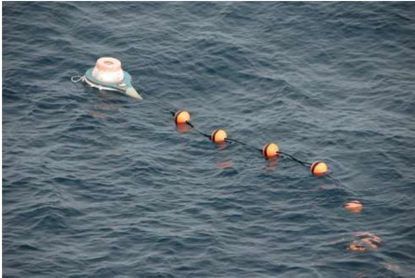
Abbildung: Die neu installierte Oberflächenboje mit auf Satellitentelefon basierter Echtzeit-Datenübertragung nach Auslegung. (Foto: M. Schneider, Kapitän)
