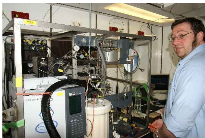
Boie Bogner bedient das Instrument zur Bestimmung von SF 6 und FCKW-12 Konzentrationen in den Wasserproben.
