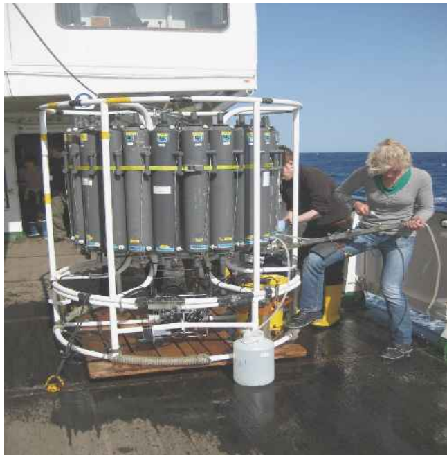
Eike Hümpel nimmt Proben zur Bestimmung der Helium-3 Isotopen Zusammensetzung. Die Probe wird mit Hilfe eines Kupferrohrs genommen, das mit rostfreien Stahlschellen verschlossen wird. Eine wirklich anstrengende Arbeit.
