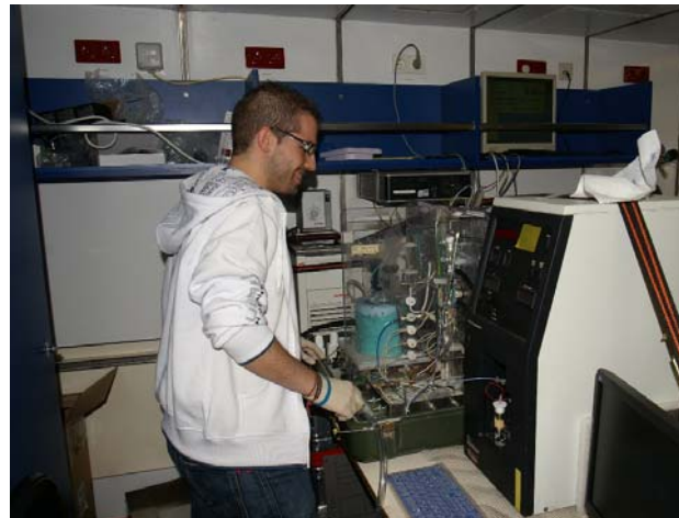
Carlos Colmenero aus IEO in La Coruna bedient ein SOMMA, d.H. ein Instrument um die gelöster anorganischer Kohlenstoff zu bestimmen.
