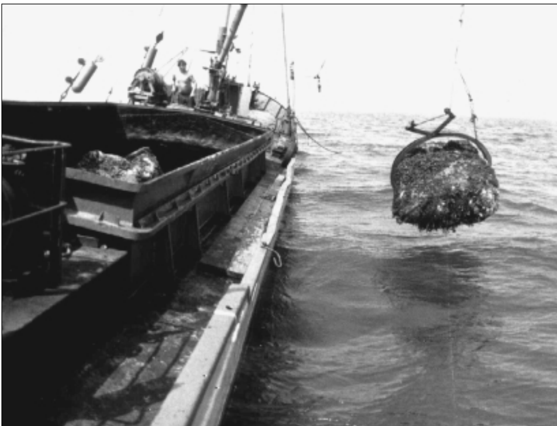
Abbildung 1: Steinzangerschiff „A.M.4“ beim Heben eines Ostseefindlings mit der Zange.
