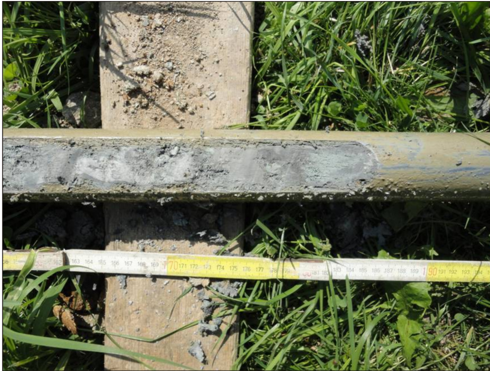
Abb. 3: Sonde mit dem erbohrten Mergel von Börnersdorf bei 7,6 – 8m in B 8/11.
