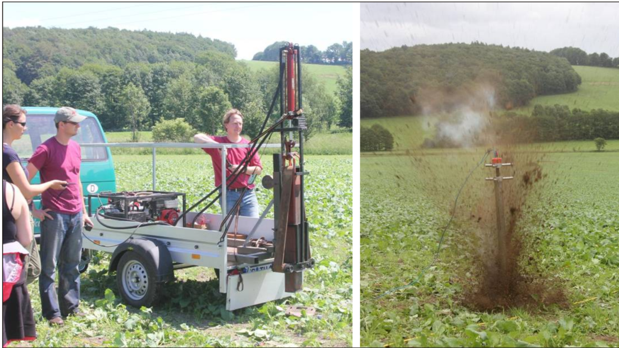
Abb. 6: Als seismische Quelle kamen das institutseigene beschleunigte Fallgewicht (links) sowie die "Impulsquelle" Sissy (rechts) zum Einsatz (Fotos: Olaf Hellwig).
