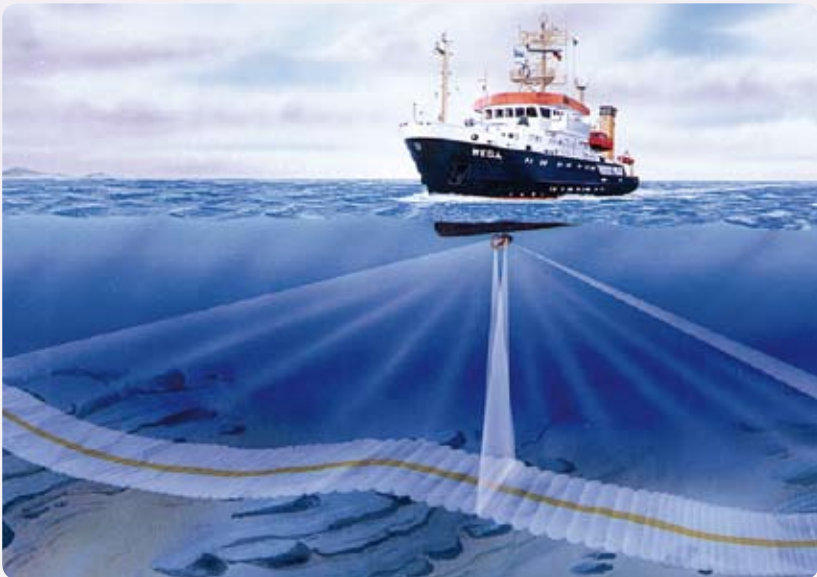
Abb. 2: Prinzipskizze eines schiffsgestützten Fächerecholotes. Der Schallimpuls wird unter dem Schiff erzeugt und als Fächer abgestrahlt. Aus der Rücklaufzeit der Signale kann ein Geländemodell errechnet werden. Quelle: Atlas Hydrographic.
