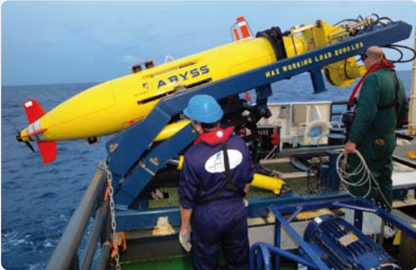
Abb. 6: Dr. Petersen (Vordergrund) beim Aussetzen des AUV ABYSS. Angetrieben wird das AUV durch den Propeller links. Die orangenen Flossen dienen zur Steuerung des Gerätes. Unter dem Schriftbild ABYSS sind die schwarzen Schallköpfe des Seitensichtsonars zu erkennen, mit dem die Suche nach den Wrackteilen durchgeführt wurde.
