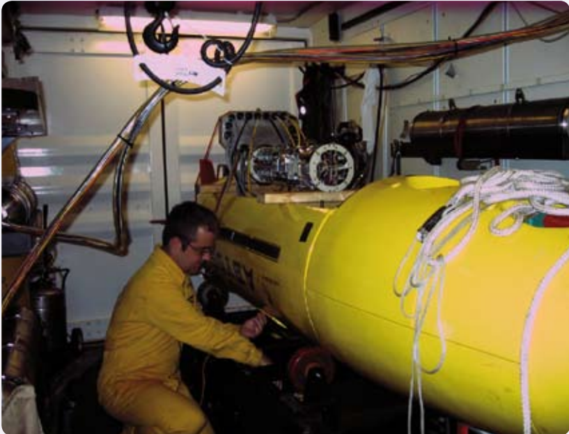
Abb. 9: Marcel Rothenbek bei Wartungsarbeiten am Gerät. Die Elektronik im AUV ist durch dicke Titanflaschen vor dem Umgebungsdruck geschützt. Im Zentrum des Bildes sieht man eine dieser Flaschen, die aus dem „Bauch“ des AUV entnommen wurde, im geöffneten Zustand.
