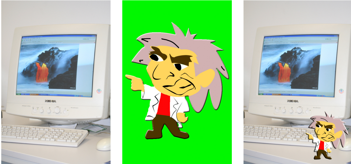
Abbildung 6.13: Veranschaulichung von Keying und Compositing: aus der realen und der animierten Bildebene wird das kombinierte Endbild
