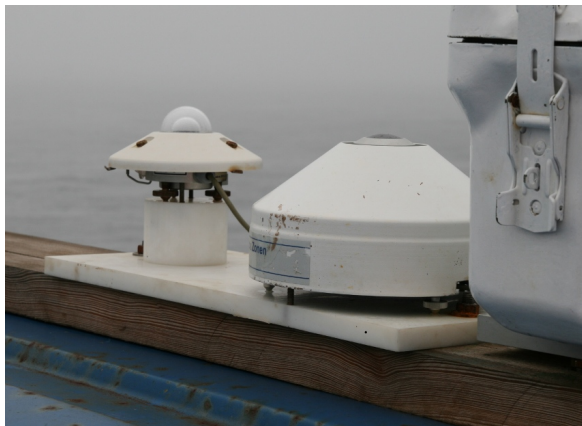
Abbildung 3.2: Das verwendete Pyranometer (links) und das Pyrgometer. Beide Geräte waren auf einem Container auf dem Peildeck angebracht.
