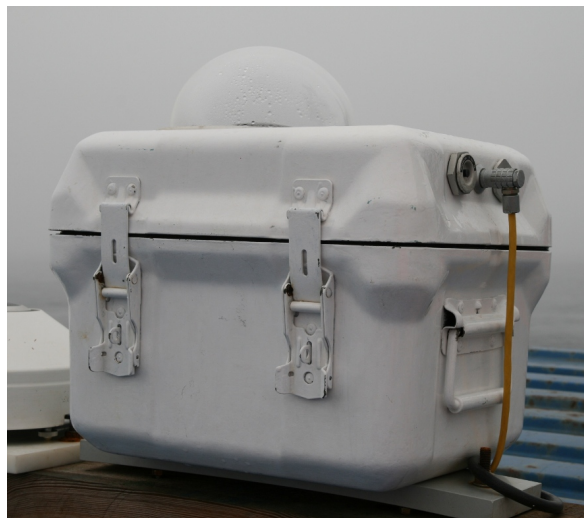
Abbildung 3.3: Die Wolkenkamera zur Dokumentation von Wolkentyp und Bedeckungsgrad. In der wasserdichten Box befindet sich unter der Glaskuppel eine Canon PowerShot A640 mit einem Fischaugenobjektiv.
