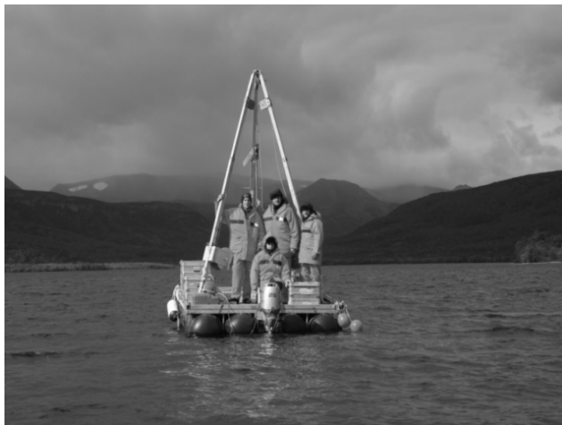
Рис. 4. Буровая плавучая установка, использовавшаяся при отборе керна из осадков на озере Двухюрточном. Снимок О.В. Дирксена.
