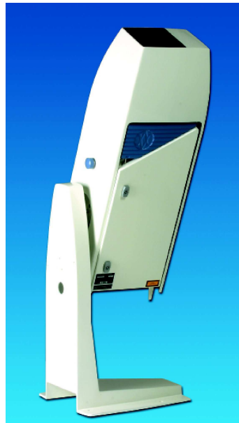
Abbildung 4.3: Ceilometer CT25K von Vaisala, Foto nach Vaisala (2005).
