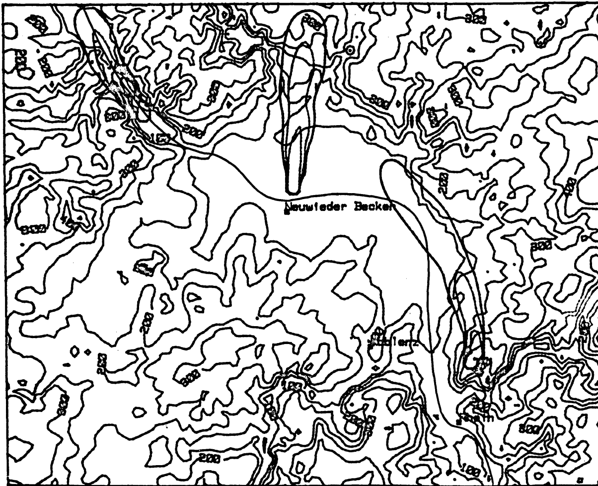
Abb. 1: Ausbreitungsrechnungen mit HEARTS in strukturiertem Gelände für drei fiktive Dauerquellen. Eingangsdaten: Stabil bei schwachem Südwind.
