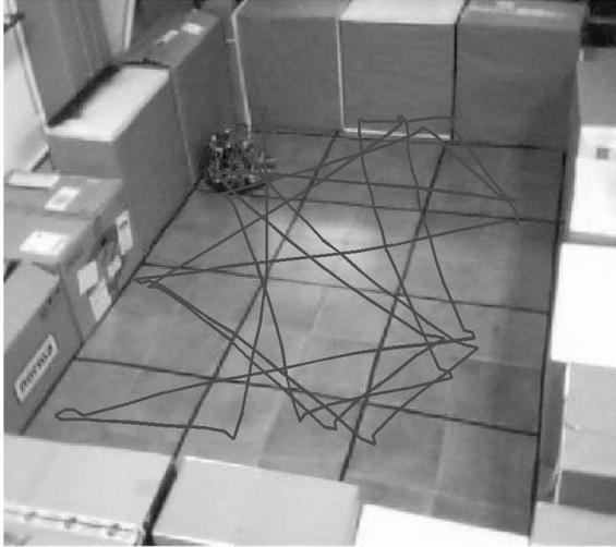
Fig.13. Trayectoria seguida por el robot en la prueba de navegación con los sensores de ultrasonido.
