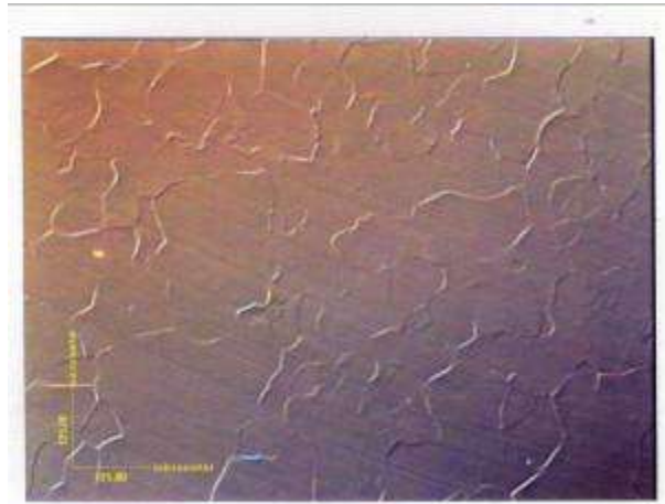
4.2.4. ábra. Kristályos szerkezetű réz tükörfelület mikroszkópi képe
