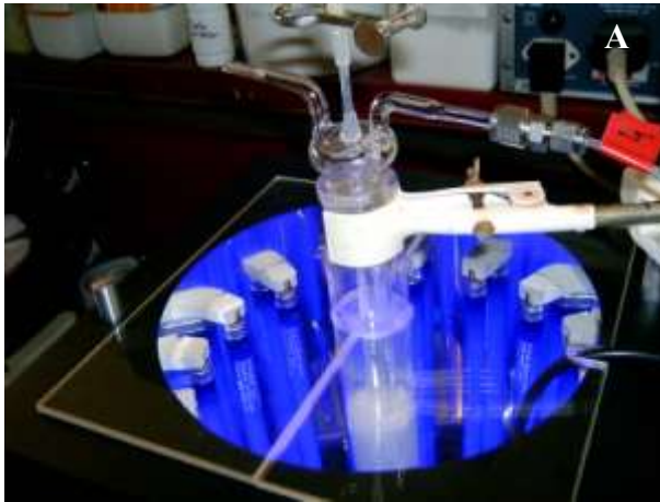
1. ábra Fotokatalitikus reaktor rendszerek TCP lebontásának tanulmányozásához
