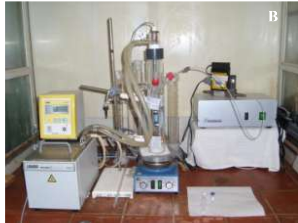
1. ábra Fotokatalitikus reaktor rendszerek TCP lebontásának tanulmányozásához
