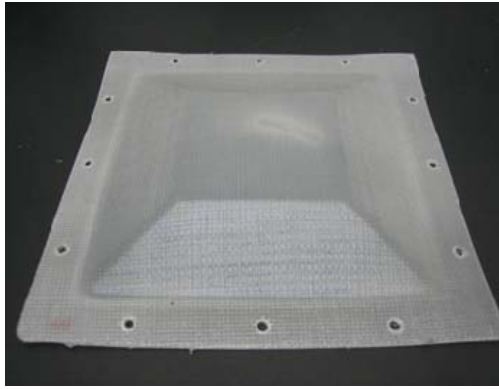
11. ábra \alpha -rPP mátrixú kompozit lapból készített termék
