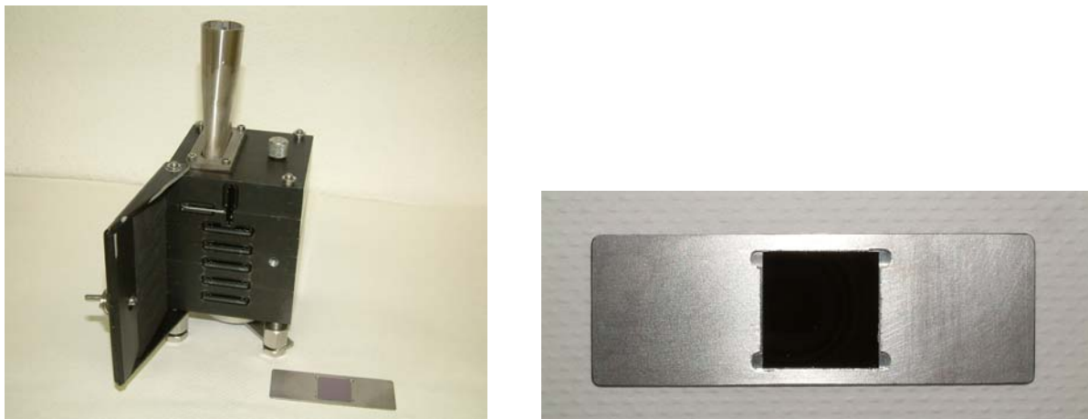
1. ábra: May-impaktor (balra), a Si lapot tartalmazó impaktorlemez (jobbra)
