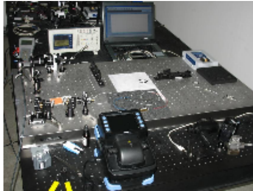
13. ábra A femtoszekundumos Yb szállézer prototípusáról készített fénykép. Előtérben a szálhegesztő berendezés, jobb oldalon fenn a pumpáláshoz használt 976 nm-en működő, 600 mW cw kimenő teljesítménnyel rendelkező lézerdióda illetve meghajtó egysége. Fent az impulzusok jellemzésére használt fotodetektor illetve oszcilloszkóp, valamint spektrométer.
