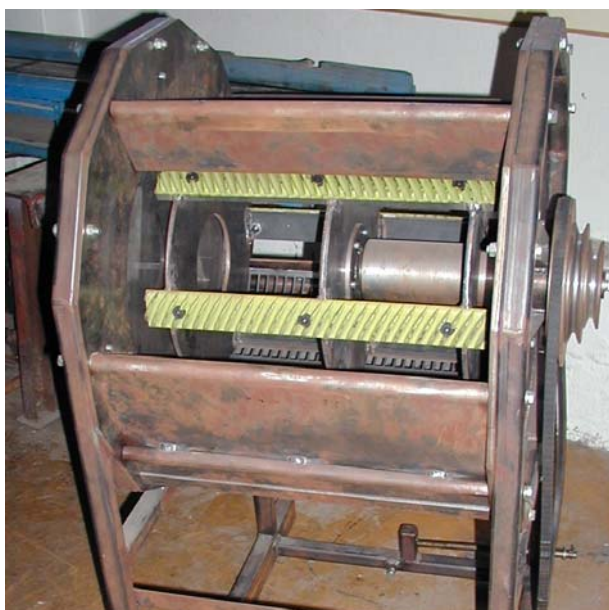
1. ábra. Verőléces-kosaras cséplő modellgép
