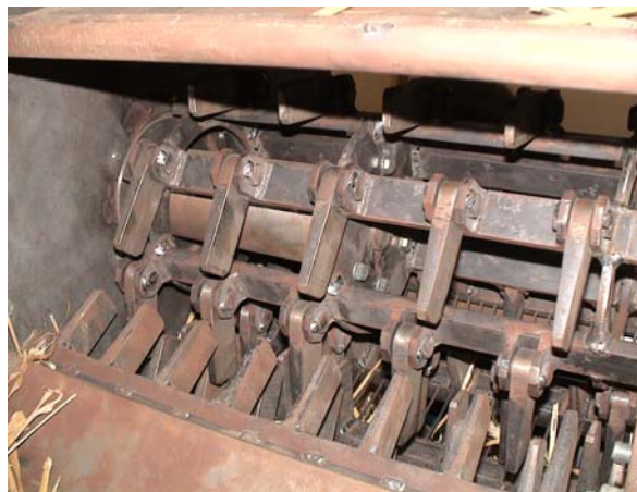
3. ábra. Lengő ujjakat szerelt dob fogas kosárral
