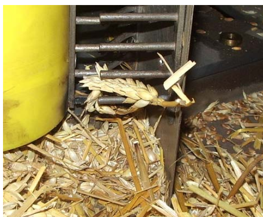
5. ábra. Kalász a cséplődob és álló tuskesor között
