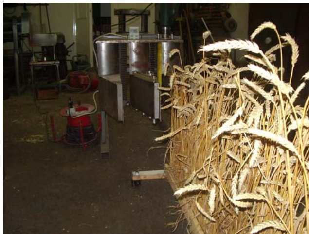
8. ábra. Etető eszköz a kalászcseplő modellgéphez
