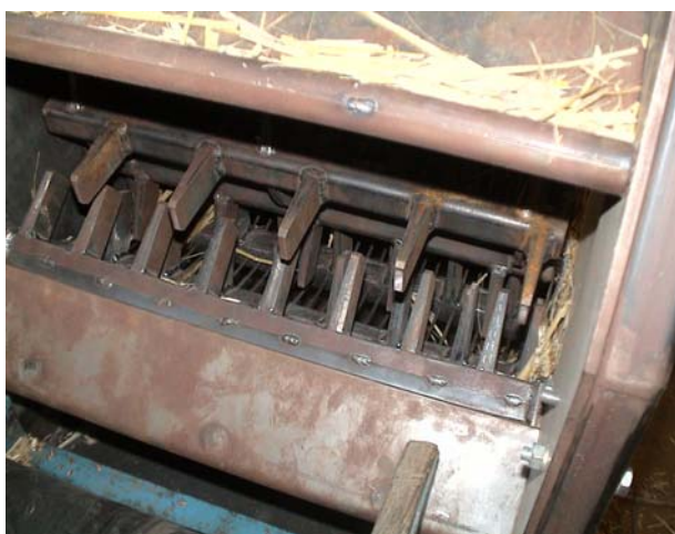
2. ábra. Fogasdobos-fogaskosaras cséplő modellgép
