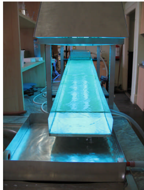
15. ábra Az általunk szerkesztett és épített nagylaboratóriumi méretű vízisztító berendezés képe
