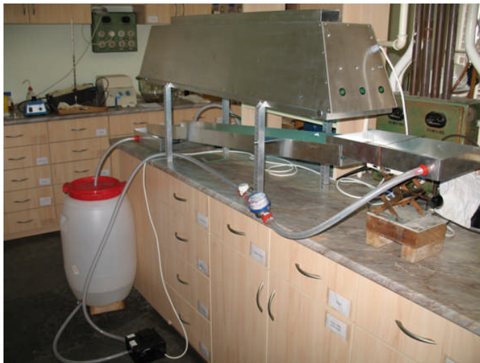
15. ábra Az általunk szerkesztett és épített nagylaboratóriumi méretű vízisztító berendezés képe
