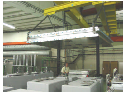
3-4 ábra. A mérendő müon-kamra elhelyezése a kamra-kalibrációs berendezésen.
