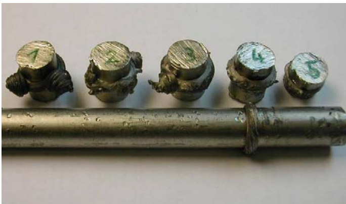
17. ábra Dörzshegesztett kötés különböző munkarenddel
