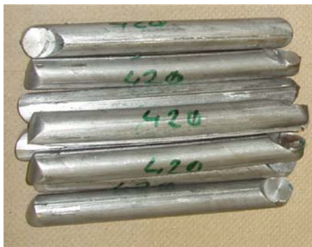
5. ábra AlMgSi1 anyagból készült könyöksajtoló próbatestek
