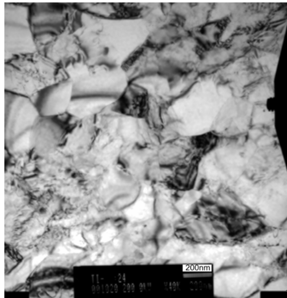
15. ábra Könyöksajtólással alakított minta a) hosszirányú és b) keresztmetszeti elektronmikroszkópos képe.
