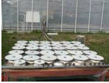
19. ábra A szolariméterek mérőhely kialakítása
