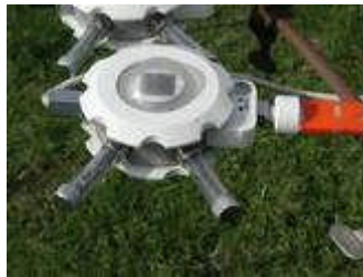
18. ábra Schenk 8111 típusú globálsugárzásmérő
