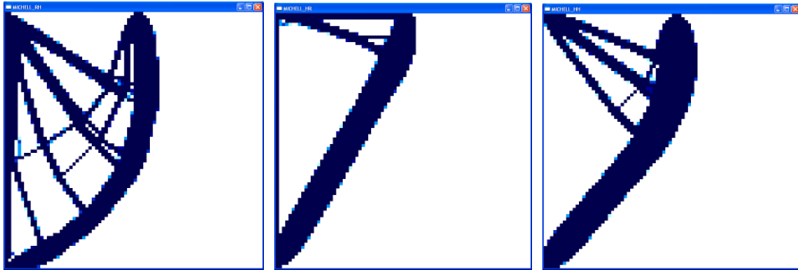
a; Görgős és csuklós támasz b; Csuklós és görgős támasz c; Csuklós és csuklós támasz 3.a-c ábra Numerikus megoldások
