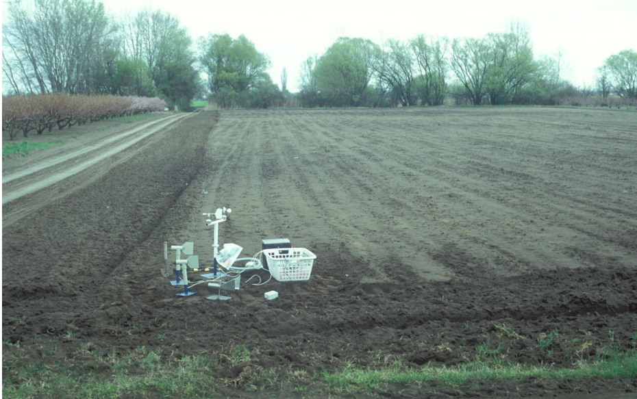
Mobil, digitális meteorológiai és széleróziós állomás (Zsombó 2004. április)
