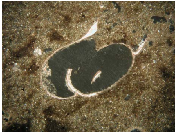
10. ábra. Biomold porozitás, csigaház metszet, agyagos kőzetliszt összetétel, elszórta homok méretű szemcsékkel, pórusok, kriptkristályos/amorf redox jelenségek (Villánykövesd 0,50-0,75 m). 1,5 x objektív, + N
