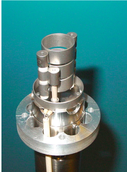
3. ábra. Az új ionoptika a pozicionáló gyűrűvel
