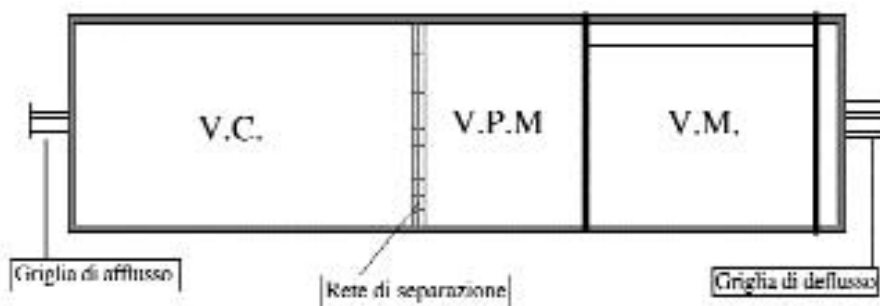
Fig. 1. Visione schematica d'insieme della vasca in cemento utilizzata per ricavare i settori V.C. a monte e V.P.M. a valle, con al suo interno la vasca di medicazione in PVC. Schematic view of the cement fish-pond divided into the 3 section.
