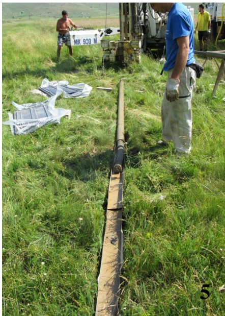
Fig. 1 Piano Locce e punto di campionamento; Fig. 2 Carotatore; Fig. 3 Punto di prelievo; Fig. 4 Carotatore in funzione; Fig. 5 Fuoriuscita di un segmento di carota; Fig. 6 Carota nelle cassette di contenimento.
