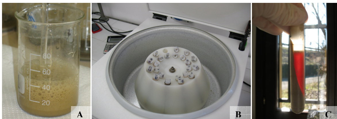
Fig. 15: preparazione dei campioni pollinici in Laboratorio: trattamento in HCl (A), centrifugazione (B), lavaggio acetolisi (C)
