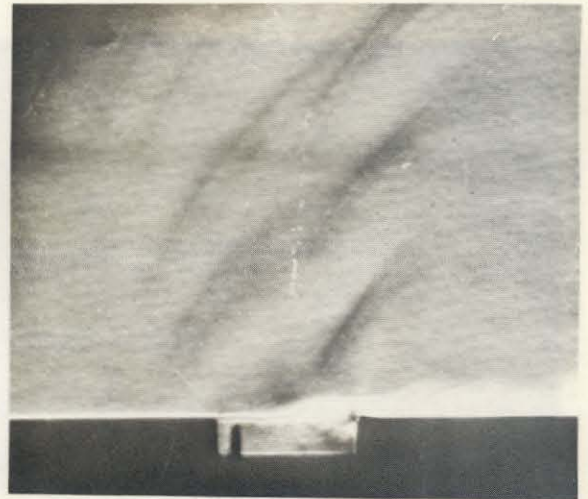
(d) d = 0.1 inch; b = 0.4 inch knife edge horizontal
