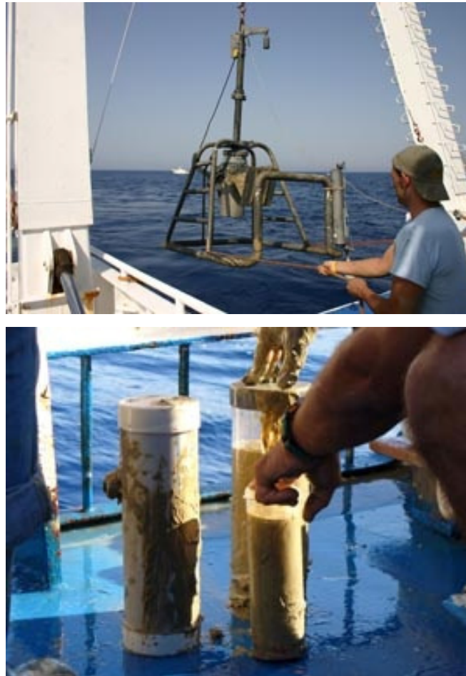
Figura 2.2 Box-corer e campionamento delle carote di sedimento.
