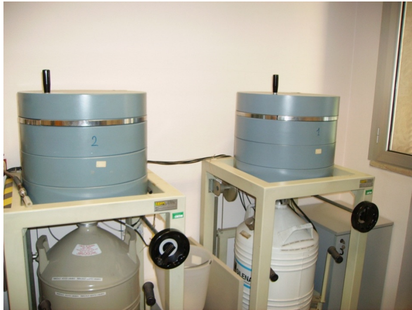
Figura 2.3 Spettrometro gamma al germanio intrinseco (HPGe).
