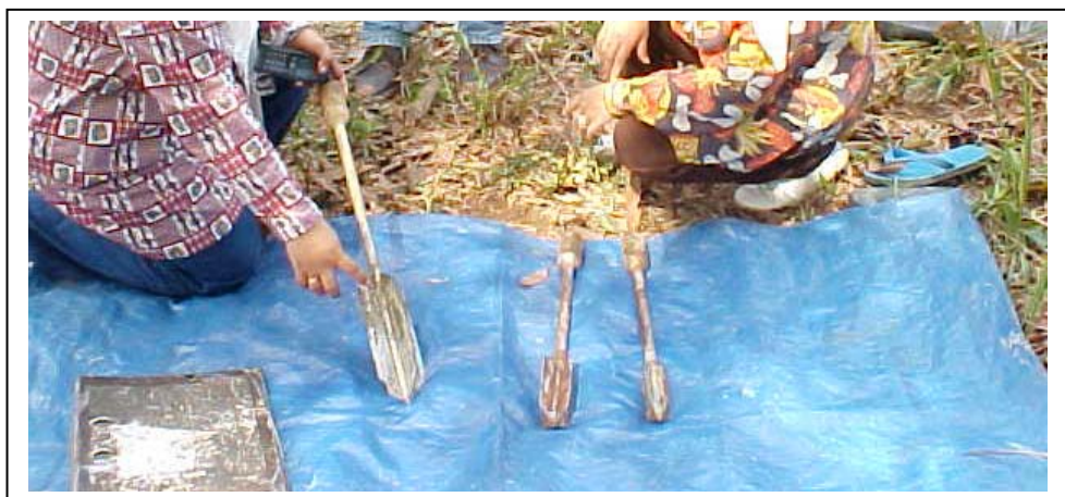
Rajah 4.13: Tiga Saiz Bilah Yang Digunakan Dalam Ujian Ricih Bilah In-Situ
