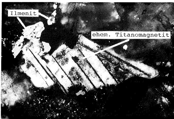
Abb. 26: Ehemaliger Titanomagnetit und Ilmenit in einer Probe der Basaltgruppe IV. Titanomagnetit ist nahezu vollständig durch nicht-opake Minerale ersetzt. (Nicols gekreuzt, unterer Bildrand = 0,87 mm)
