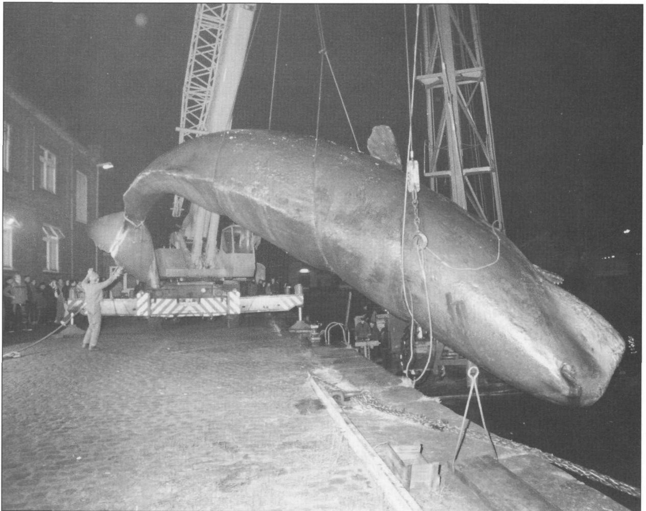
Der 100-Tonnen-Autokran und der 25-Tonnen-Schwimmkran heben gemeinsam den Pottwal auf die Kaje.
