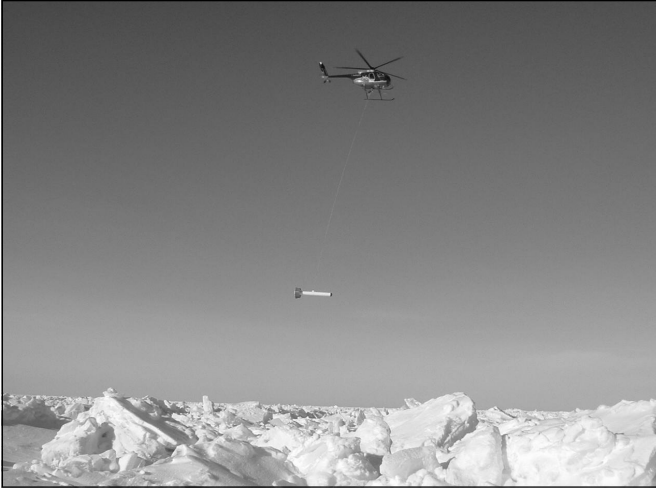
Abb. 2.7-5: Hubschrauber mit EM Eisdickensonde, die es seit kurzem erstmals ermöglicht, Eisdickenmessungen aus der Luft durchzuführen (Foto: J. Wilkinson).
