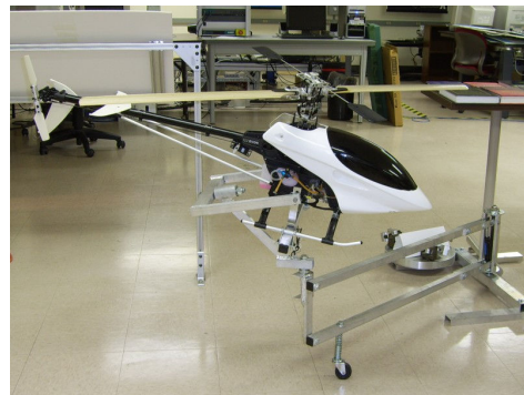
Şekil 2: Genel amaçlı İHA test platformu
