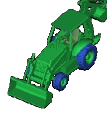
Şekil 3: Saçılım öngörülerinde kullanılan iş makinesi (bekho) modeli
