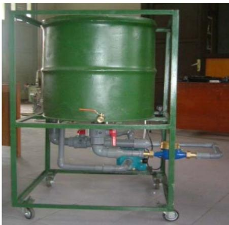
Gambar 11. Sistem umum *quenching* dengan air tersirkulasi
