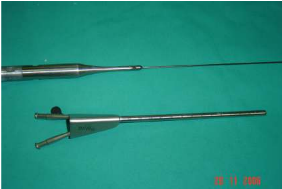
Slika 3.2. Ultrazvučni pretvarač s mehaničkim koncentradorom i sonotrodom od titana promjera 1,6 mm za endoskopsku primjenu; ventrikuloskop
