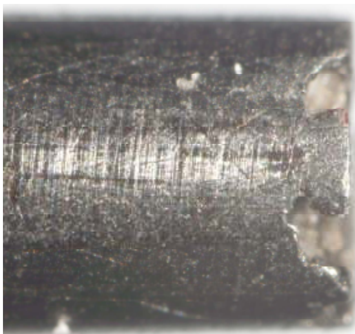
Slika 5.2. Oštećenje kavitacijom ultrazvučne kontaktne sonde.
