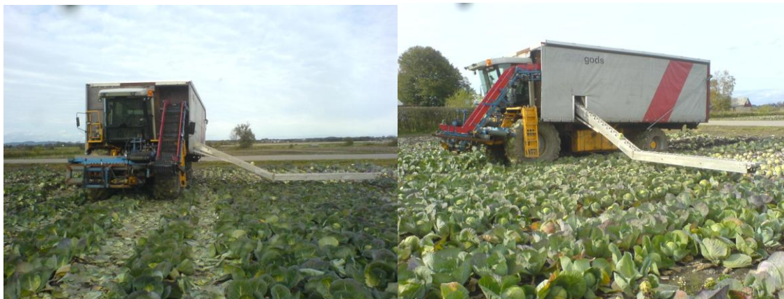
Bild 8 och 9. Självgående skördevagn byggd på en begagnad betupptagare. Vitkålen skördas antingen maskinellt via skördehuvudet från Asa-Lift, monterat fram på skördevagnen, eller manuellt via skördebandet på sidan av skördevagnen. Foto: Sven-Erik Svensson.
