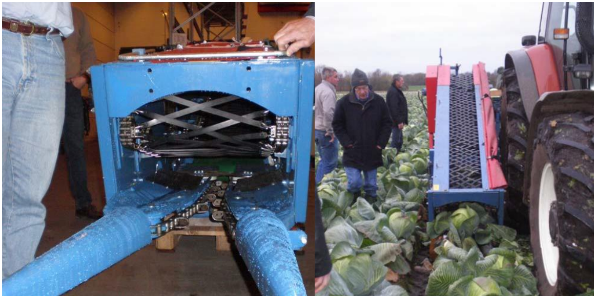
Bild 3 a och b. Närbild av styrtorped och klinga på Asa-Lifts skärenhet.
