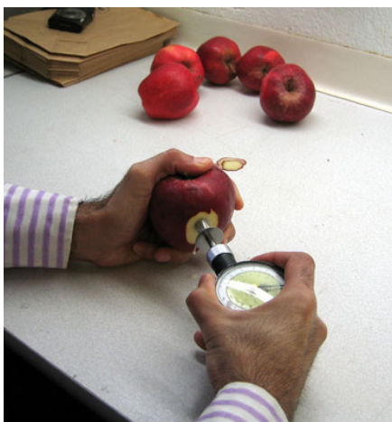
Fig. 3. Äpplets hårdhet mäter man enklast med en penetrometer.
