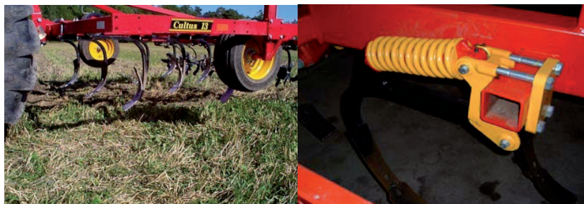
Figur 1. Kultivator i serie R2-4027. Till vänster, kultivator med fjädrande pinne. Till höger, kultivator med stel pinne, använd vid bearbetning till 20 cm 2005 och 2006.
