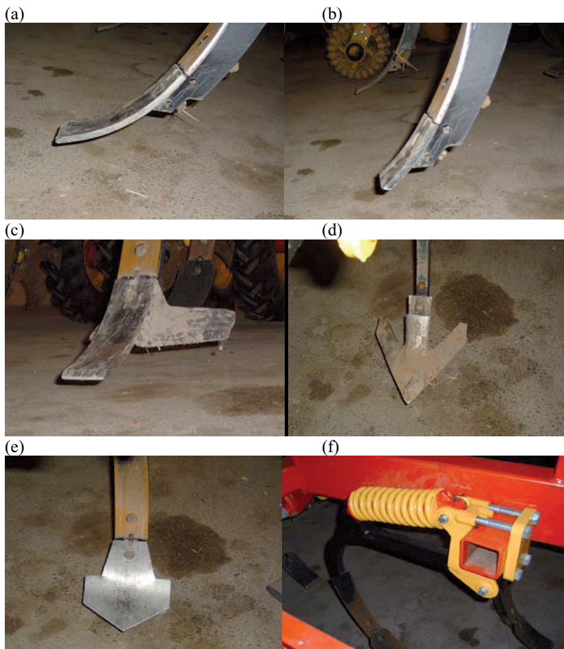
Figur 9. Några av de använda spetsarna och den mekaniska stenutlösningen. 80 mm (a), sliten 80 mm (b), 80 mm med vingskår (c), gåsfot (d), 210 mm (e) och stenutlösningsfjäder (f).
